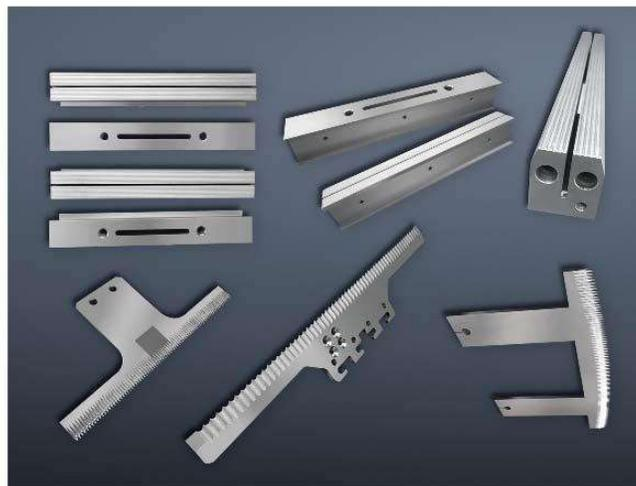
◆锋特利包装机配件加工厂生产的立式包装机切刀产品可采用SK5高碳钢、420J2或440C马氏体不锈钢及高速钢材料，近年来行业客户内对包装机切刀越来越严格的要求，我公司采用的420J2和440C不锈钢来加工切刀，材料热处理硬度达到HRC54-59，表面抛光处理，可在长时间有水分和腐蚀的环境中保持不生锈，经过高精度磨床及线割加工后再用CBN砂轮磨齿而成，齿刀口锋利、精确度高、调试方便、耐磨耐用，降低客户频繁更换刀片次数，提高包装机整体厂家的制造档次和水平。
