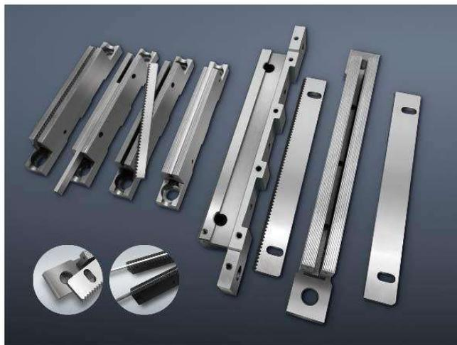
◆锋特利机械包装机配件厂专业提供国内外各大厂家枕式、立式包装机配件、封口器、横封辊、纵封辊、切刀、刀座。常年配有各类标准现货及半成品，非标定制产品也可加工订制，交货时间短。封口材料主要采用锻打的T10、40Cr及H13来加工，回火处理到粗加工后再调质处理，表面涂镍后光亮如镜，不易生锈。其中H13合金钢特别使用在超长的热切刀和加热刀座上，刀体加热后不易变形，可保证刀口在同一直线，封口后的产品整齐，美观。公司可加工孔深长度1500mm，孔径在5mm-20mm。
