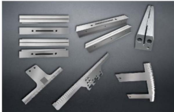
• 锋特利包装机配件加工厂生产的立式包装机切刀产品可采用SK5高碳钢、420J2或440C马氏体不锈钢及高碳钢材料，近年来行业客户对包装机切刀越来越严格的要求。我公司采用的420J2和440C不锈钢来加工切刀，材料热处理硬度达到HRC54-59，表面抛光处理，可在长时间有水分和腐蚀的环境中保持不生锈，经过高精度磨床及线割加工后再用CBN砂轮磨齿而成，齿刀口锋利、精确度高，调试方便、耐磨耐用，降低客户频繁更换刀片次数，提高包装机整体厂家的制造档次和水平。
