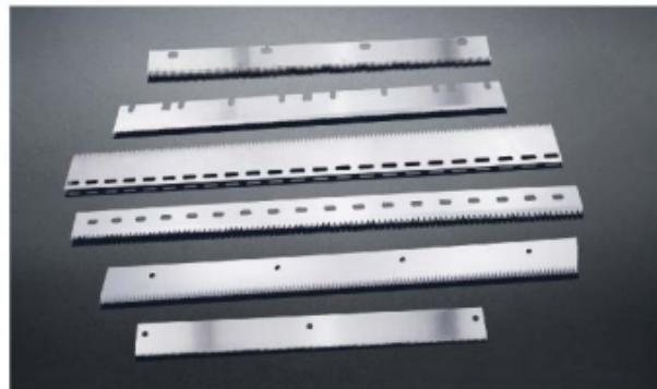
用于切割虚线的长齿超薄刀片,可切割各类超市手撕袋,纸袋和无纺布袋,切出来的产品撕不粘,并能良好的保持袋制品的密封性,是各大制袋厂家的首选刀具。常用虚线规格 2.5\*0.5, 3\*1, 5\*2等。我公司精制的适用于立式包装机刀片配套于国内各知名企业,可以切割各类食品包装袋,刀片材料选用 SK5/440C/SKD11/SKH-9 等以适合不同档次的用户, 国内领先的全自动数控磨机加工磨齿,使切割的产品切口平整,无毛刺, 标准产品常年配有现货, 非标产品按图纸加工。
